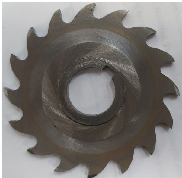
Рис. 2. Износ фрезы общий вид
