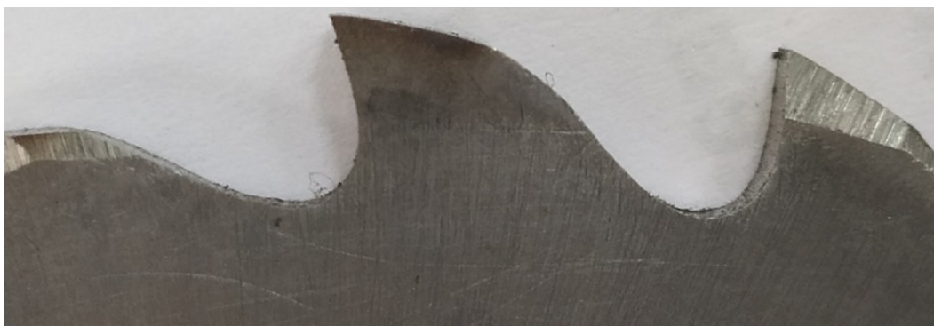
Рис. 3. Износ режущего зуба фрезы
