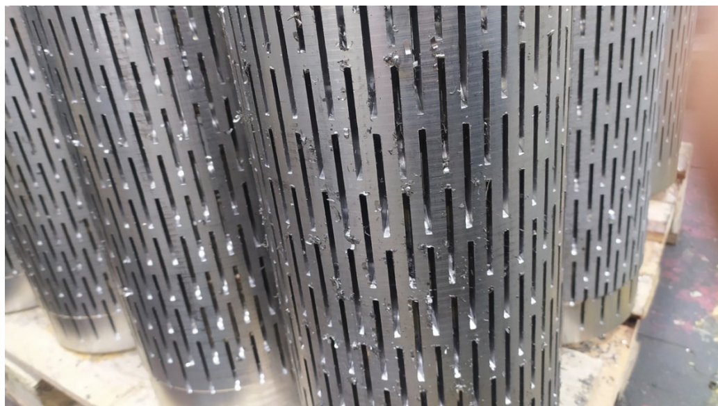
Рис. 5. Выступы в виде заусенцев снаружи детали
