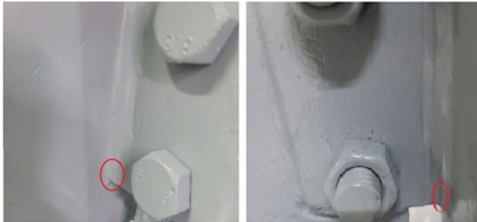
Рис. 5. Разрушения на образце с катетом швам 8 мм
