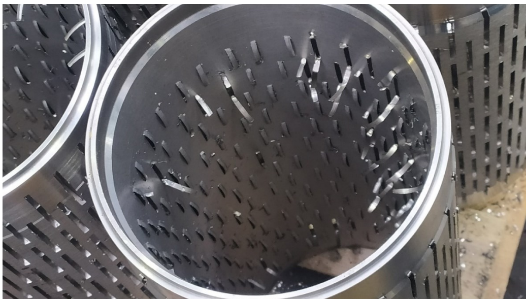
Рис. 4. Дефекты в виде заусенцев внутри детали
