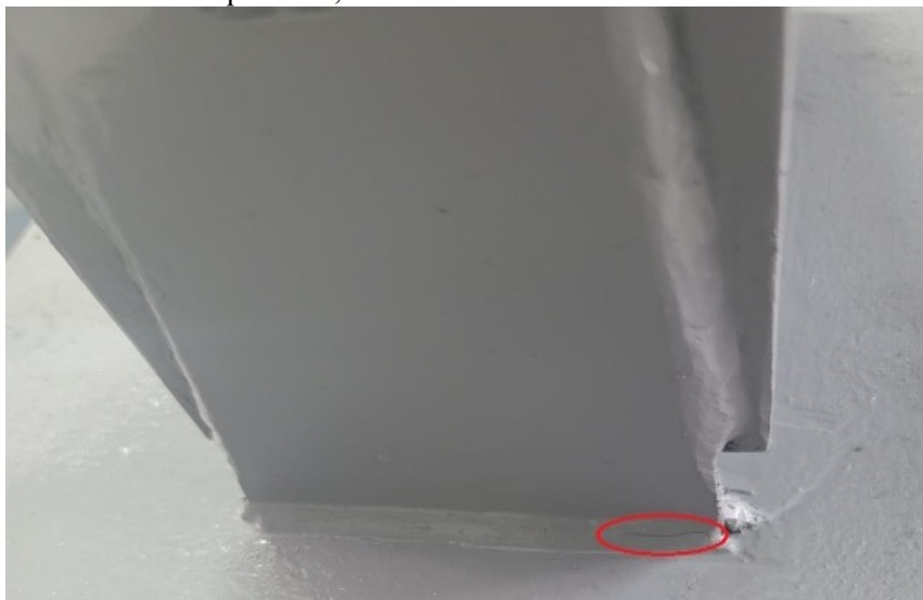
Рис. 7. Разрушения на образце с катетом шва 8 мм
